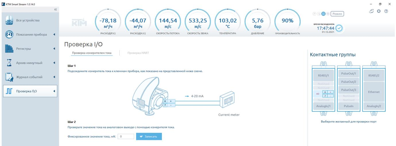
Рисунок 38 – Проверка аналогового выхода измерителем тока
