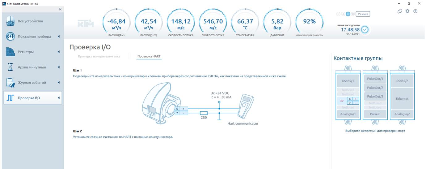
Рисунок 39 – Проверка HART аналогового выхода
